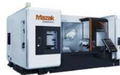
Centre multitâches INTEGREX I-200ST Bi-Broche / Embase 1500 mm Magasin 36 outils CAPTO C6 Broche de fraisage 12 000 tr/min 24 Kw
